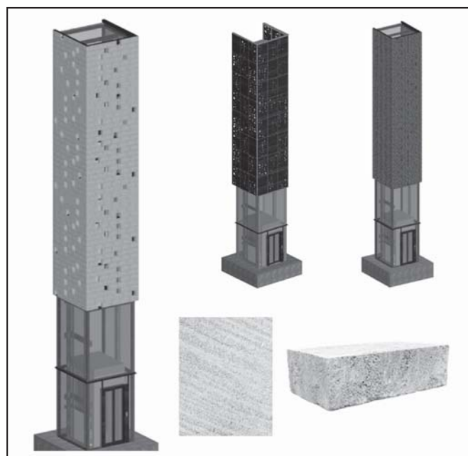
Figura 5 - Le tre ipotesi proposte per il rivestimento dei sistemi ettometrici di risalita e la soluzione scelta (a sinistra).
